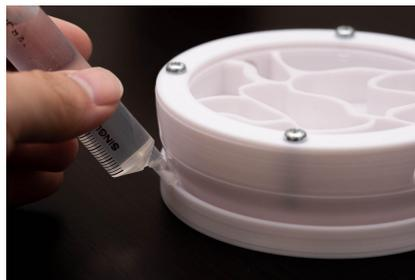
水を入れる際は、シリンジなどの口を無理に隙間に押し当てる必要はなく、土台部の壁面に水を当てるようにすると良い感じに下に流れていきます。
